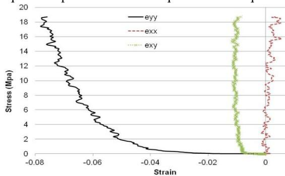
Figure 1 : Déformations mesurées sur un joint sec (MaC)
