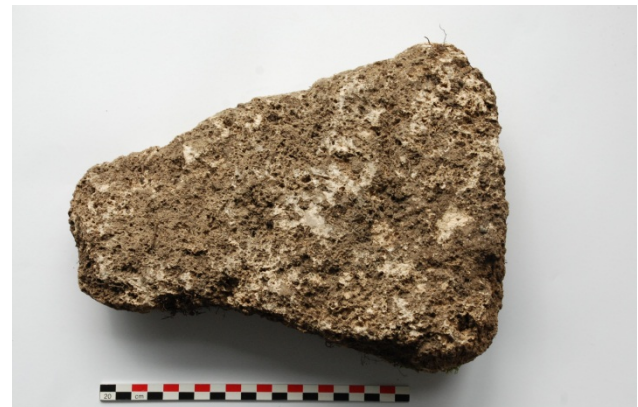
Figure 27 : Moellons taillés dans du tuf et découverts dans l'U.S. 15000
