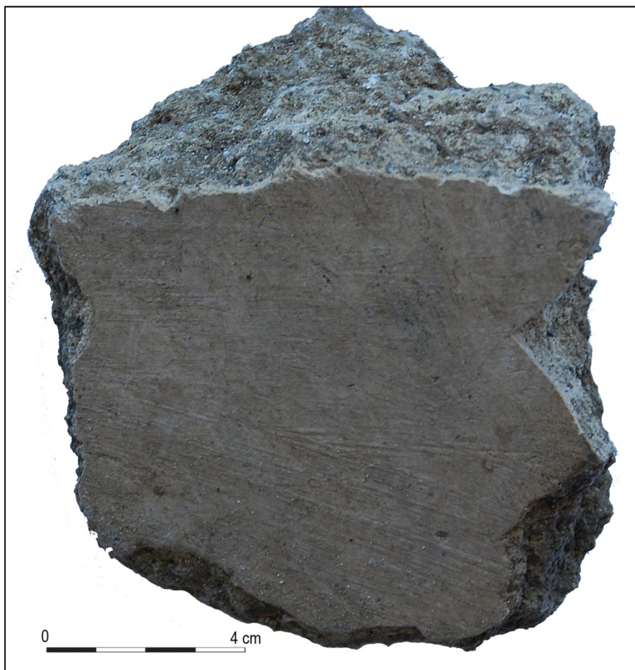
Fig. 8 : Enduit couvert d'une peinture de couleur blanche. Notez qu'il s'agit toujours de blanc cassé et que la peinture ne comble pas les irrégularités du lissage.
