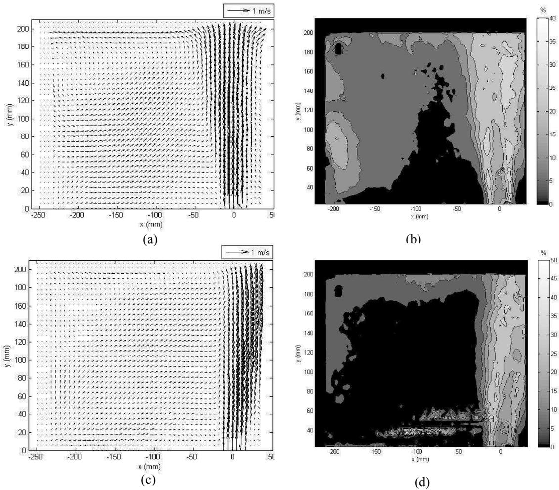
Figure 3 : Champs de vitesse et intensité des fluctuations de vitesse longitudinale dans la moitié de l'enceinte située près de l'ouverture E;  $H_e = 36\text{mm}$  ;  $H_s = 16\text{mm}$  : (a) et (b) ;  $H_s = 46\text{mm}$  : (c) et (d)
