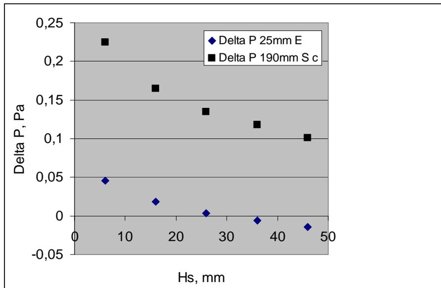
Figure 4 : Variation de la différence de pression de part et d'autre des ouvertures E et S en fonction de la hauteur de l'exutoire  $H_s$ .
