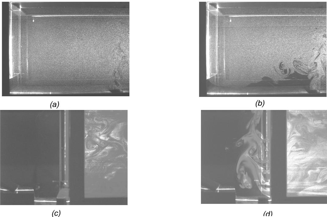
Figure 2 : Visualisations de l'écoulement dans la moitié de l'enceinte située du côté de E : (a)  $H_s=26$  mm, (b)  $H_s =46$  mm et en sortie de E : (c)  $H_s=46$ mm , (d)  $H_s =16$ m ;  $H_e=36$ mm
