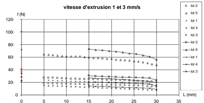
Figure 3. Effort d'extrusion en fonction de la position du piston (essais à 1mm/s : points isolés, essais à 3mm/s : courbes continues).
