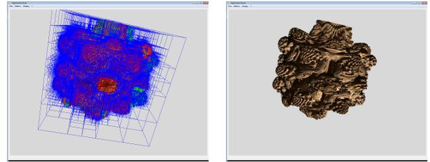
**Figure 1:** Octree (gauche) et structure de données (droite) d'un Mandelbulb
