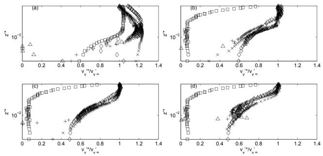
Fig. 15. Longitudinal non-dimensional velocity profile  $v_y'^*/v_{y_\infty}'$  of the non-cavitant flow, at (a)  $y^*=0$ , (b)  $y^*=0.5$ , (c)  $y^*=1$  and (d)  $y^*=2$ .  $\times$ : plate  $0, \diamondsuit$ : plate 2, +: plate  $3, \diamondsuit$ : plate  $4, \diamondsuit$ : plate
