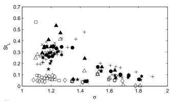
Fig. 13. Strouhal number  $St_L = \frac{Lf_L}{v_{throat}}$  according to the cavitation number  $\sigma$ :  $\times$ : plate 0,  $\bigstar$ : plate 1,  $\triangle$ : plate 2,  $\star$ : plate 3, +: plate 4,  $\bigstar$ : plate 5, +: plate 6,  $\diamondsuit$ : plate 7,  $\square$ : plate 8.
