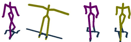
Figure 3: Illustration de la reproduction de mouvement par tracking. Figure de gauche : posture de référence (à gauche), posture initiale (à droite). Figure de droite : le mouvement de référence (à gauche) et le mouvement calculé (à droite).
