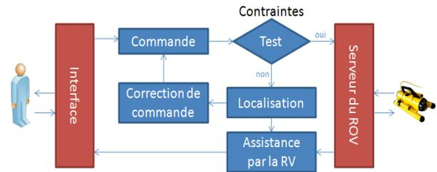
Figure 2. Diagramme architectural du système de téléopération du ROV
