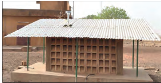
Figure 7 - Implantation d'un nouvel instrument de mesures d'aérosols à la station météorologique de Dédougou au Burkina Faso, en mars 2012. (© R. Belleville, Terra Deserta Expéditions)
