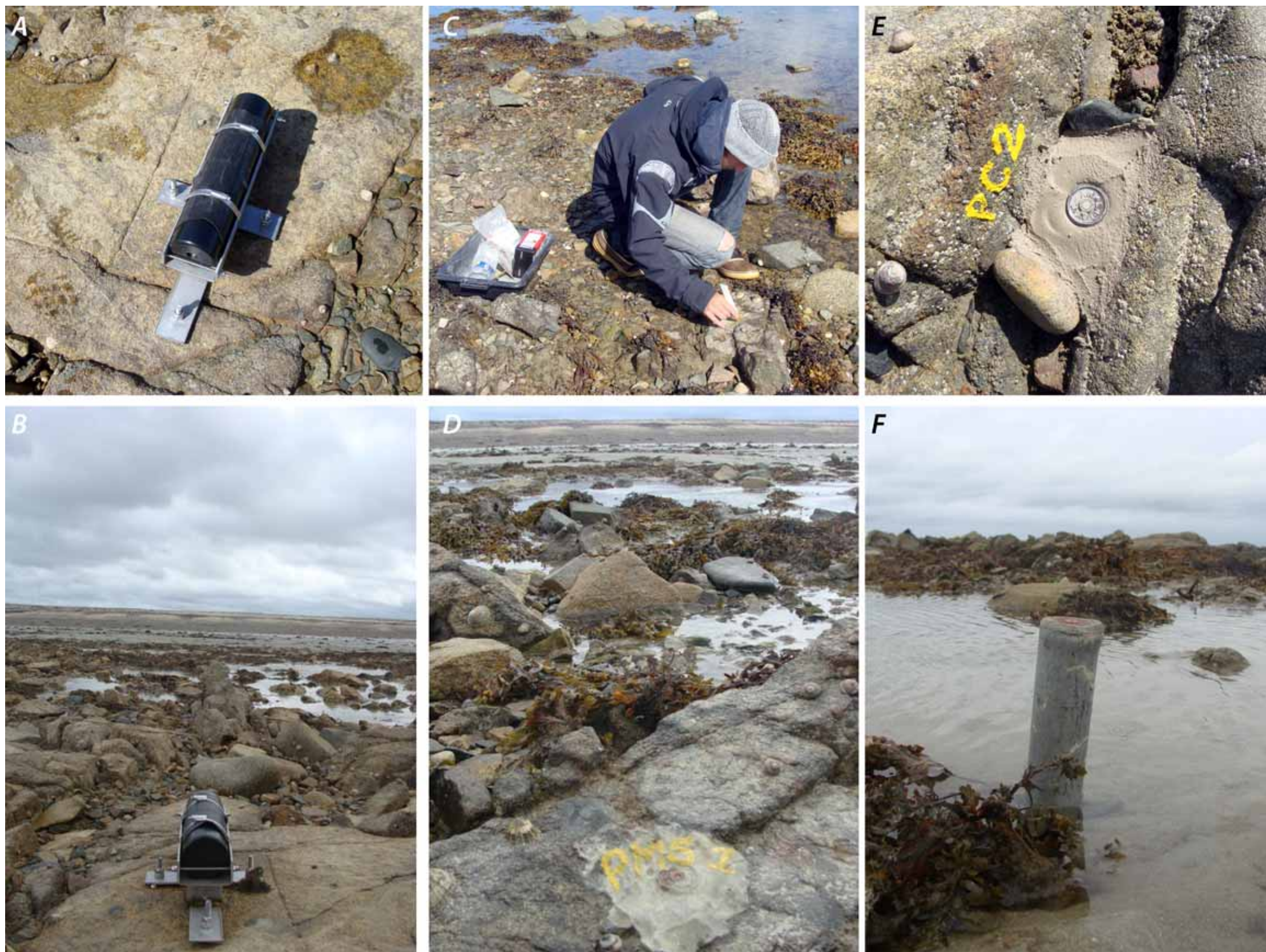
Figure 10 : A et B. Capteur de pression sur son socle inox installé sur le platier rocheux. C. Installation des repères topographiques. D et E. Clous topographiques matérialisant les points de calage PC2 et PMS1. F. Piquet en acier implanté sur l'estran pour fixer l'alignement des profils.
