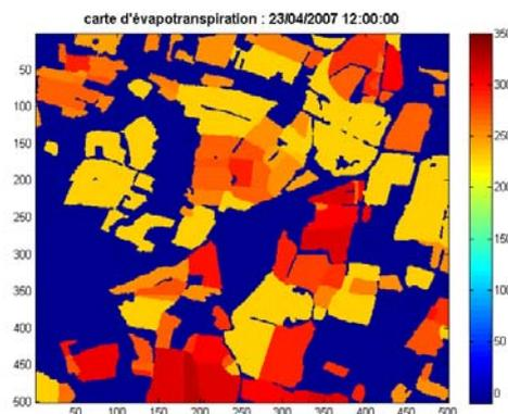
**Figure 11** : Exemple de résultat de spatialisation : carte d'évapotranspiration (en watts/m<sup>2</sup>) obtenue à l'aide d'un SVAT piloté par des données météo et satellitaires de résolution 8 m. La zone, de 4x4km, est centrée sur le site instrumenté de Lamasquère dont les données ont été utilisées pour valider le SVAT. (Rivalland, communication personnelle)
