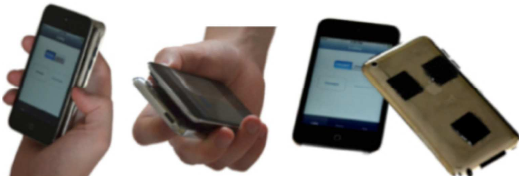
FIG. 1 - Prototype du dispositif : deux iPods Touch collés dos à dos [8] : liaison Wi-Fi (via un serveur) ou Bluetooth entre les deux iPods Touch.
