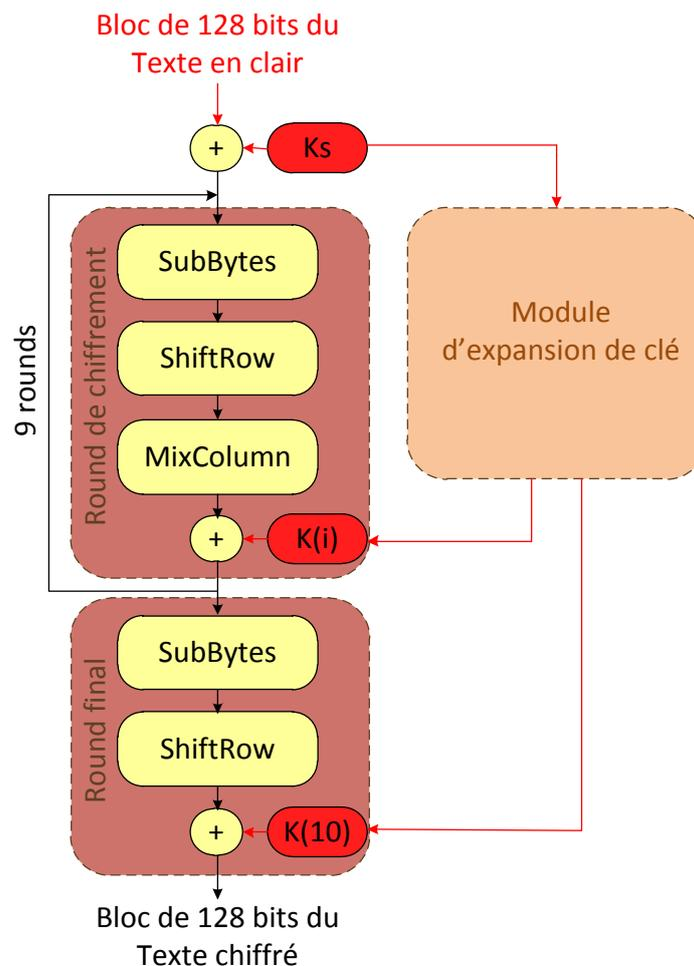
Figure 4 – Principe du chiffrement AES 128 bits.
