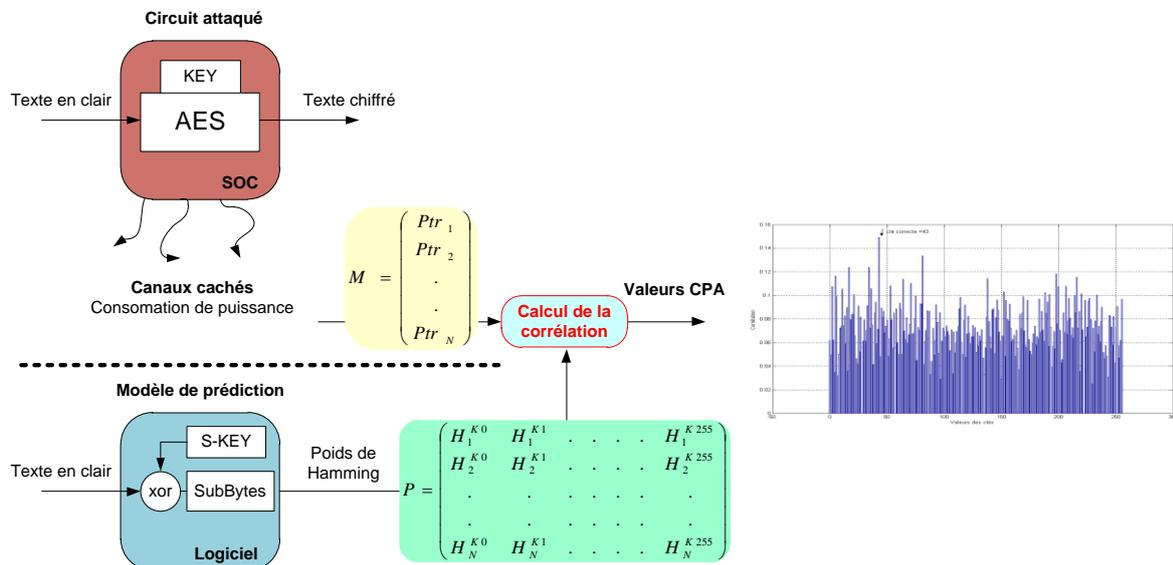
Figure 6 – Principe de l'attaque par corrélation, CPA.
