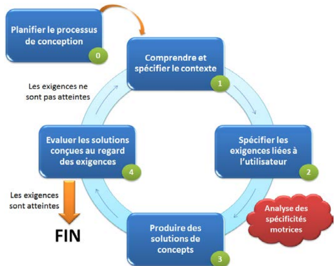
Fig.1. Modèle UCD tiré de la norme ISO 9241-210
