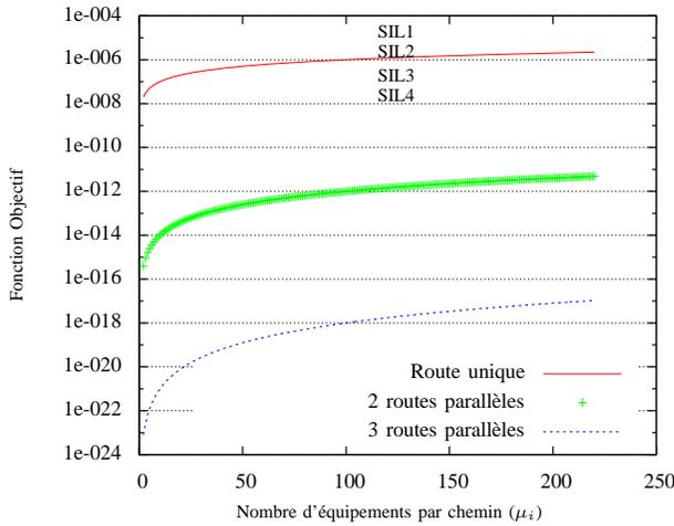
FIGURE 9. Analyse de fiabilité pour des chemins indépendants
