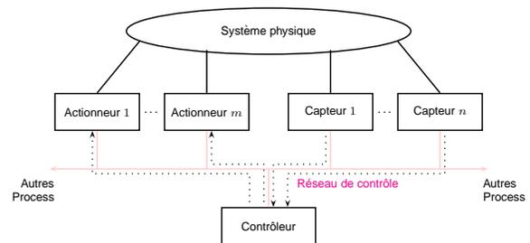
FIGURE 1. Vue traditionnelle des systèmes contrôlés en réseau [1]
