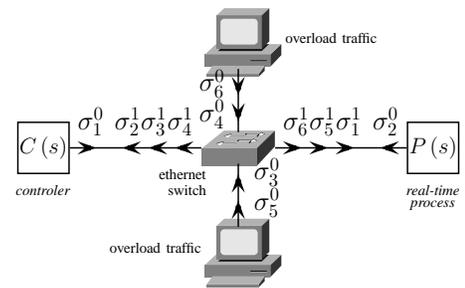
FIGURE 6. Plateforme expérimentale (les paramètres  $\sigma_i^j$  représente l'avalanche maximale de données pour un flux  $i$  après la traversé de  $j$  commutateurs)
