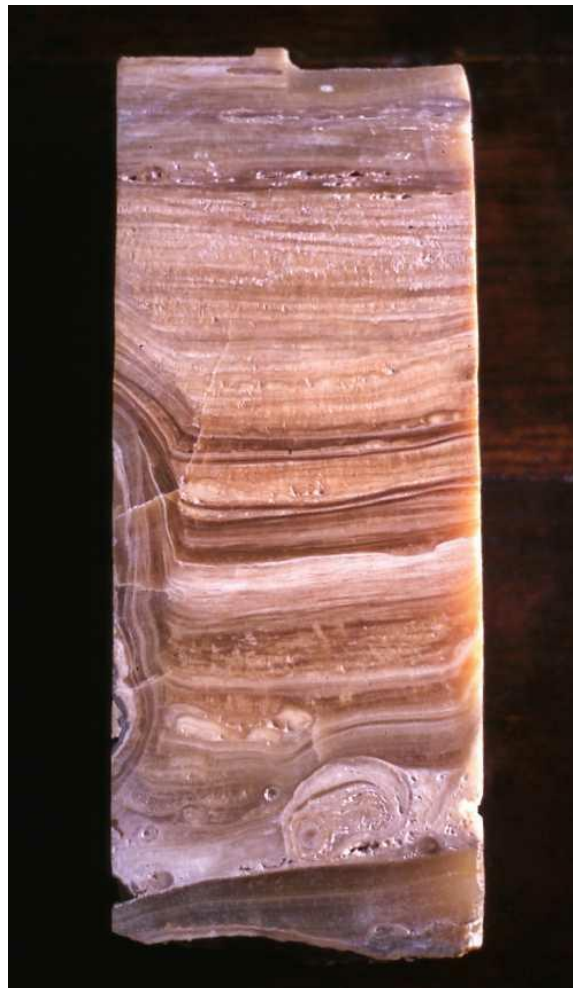
Phot. 4: Polished section of the sample where different collapse levels are visible (cave of the Observatoire, Monaco). Coupe polie de la carotte montrant différents niveaux de chutes dans la grotte de l'Observatoire (Monaco).
