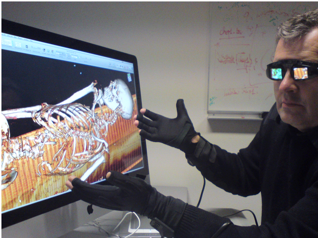
Fig. 4 : les environnements virtuels permettent la vision stéréoscopique des objets numériques 3D et leur manipulation directe à l'aide de gants de données.
