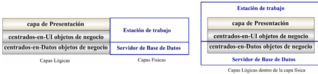
Figura 48. Dos vistas de la misma arquitectura de Tres capas lógicas y Dos capas físicas (procesamiento)
