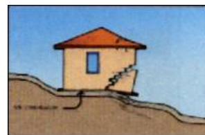
Figura 104. Vulnerabilidad alta: Cimentación
