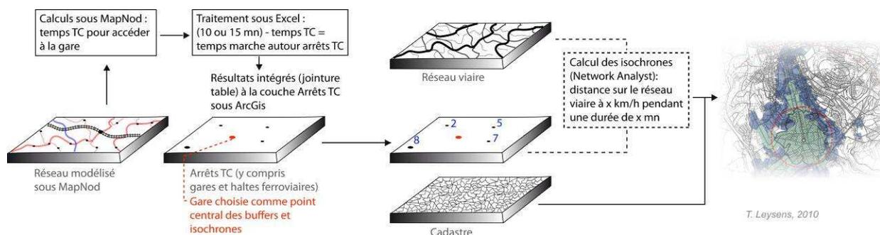
Figure 37 Processus d'élaboration des isochrones marche + transports collectifs. Réalisation: T. Leysens, 2010<sup>136</sup>
