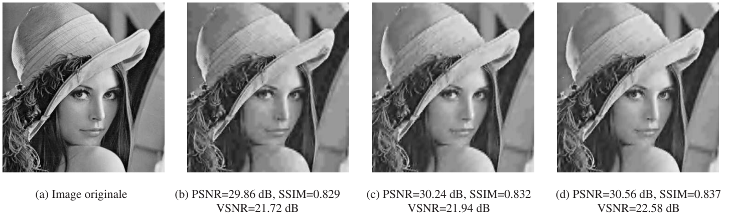
FIG. 2 – Images “lena” reconstruites à 0.125 bpp en utilisant (b) NSLS(2,2) (c) NSLS(2,2)-OPT-L2 (d) NSLS(2,2)-OPT-WL1.
