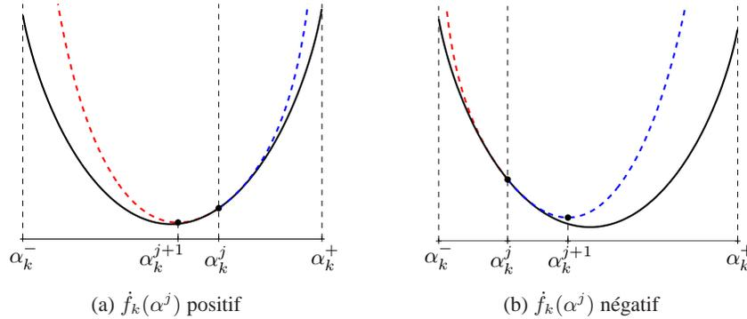
**Figure 7.** Principe de la recherche de pas MM pour le critère du maximum d'entropie. La fonction tangente majorante  $h_k(\cdot, \alpha_k^j)$  (pointillés) pour  $f_k$  (ligne continue) en  $\alpha_k^j$  est définie par morceaux sur  $(\alpha_k^-, \alpha_k^j]$  et  $[\alpha_k^j, \alpha_k^+)$ . Son minimiseur fournit la prochaine itérée  $\alpha_k^{j+1}$ . Il s'obtient en minimisant la portion gauche (Cas (a)) ou droite (Cas (b)) suivant le signe de  $\dot{f}_k(\alpha_k^j)$
