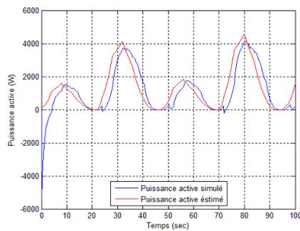
**Figure 14.** *Puissance active de la génératrice*
