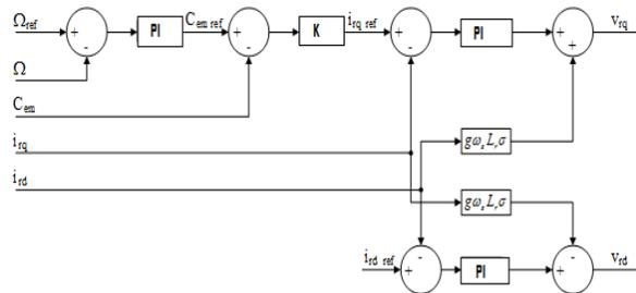
Figure 10. Structure de la commande en vitesse
