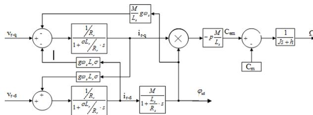
**Figure 7. Modélisation de la génératrice asynchrone double alimentation**
