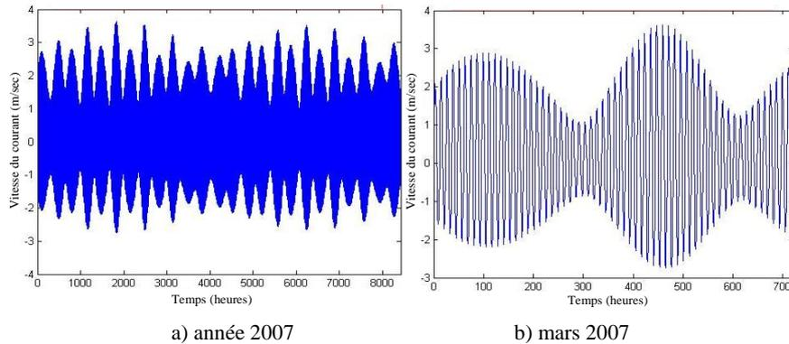
**Figure 3.** Vitesses des courants de marée dans le Raz de Sein pour l'année 2007 et le mois mars 2007
