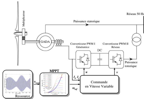
Figure 9. Principe de la stratégie de commande
