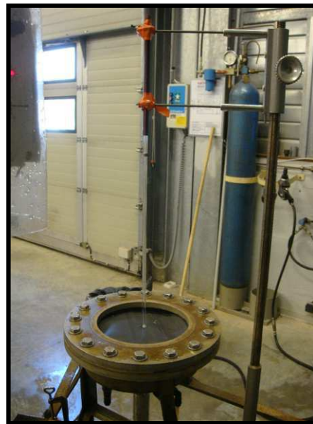
Figure 3. Dispositif d'essai de traction équi-biaxiale avec le système de mesure de déflexion (CEMAGREF-Antony)
