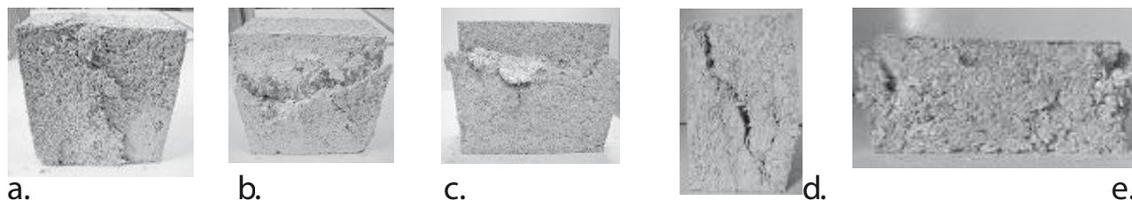
Fig. 4. Illustrations de différents faciès de rupture. (a) Éprouvette de Type A ; (b) éprouvette de Type B ; (c) éprouvette de Type C ; (d) demi-éprouvette verticale (Type C), sollicitée sur la face  $15 \times 16 \text{ cm}^2$  ; (e) demi-éprouvette horizontale (Type B), sollicitée sur la face  $30 \times 15 \text{ cm}^2$ .
