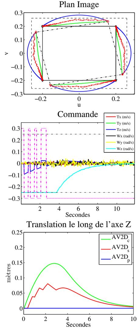
FIGURE 5. Rotation pure autour de l'axe optique avec contraintes de visibilité
