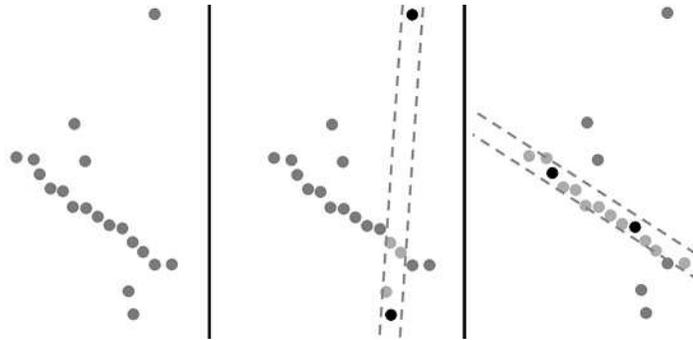
**Figure 6.** Application de RANSAC à la détection d'une droite. Les points noirs sont les points sélectionnés au hasard pour estimer le modèle de la ligne droite. Les lignes en pointillés représentent la marge d'erreur tolérée par le modèle. Les points en gris clair sont les inliers validés par le modèle.
