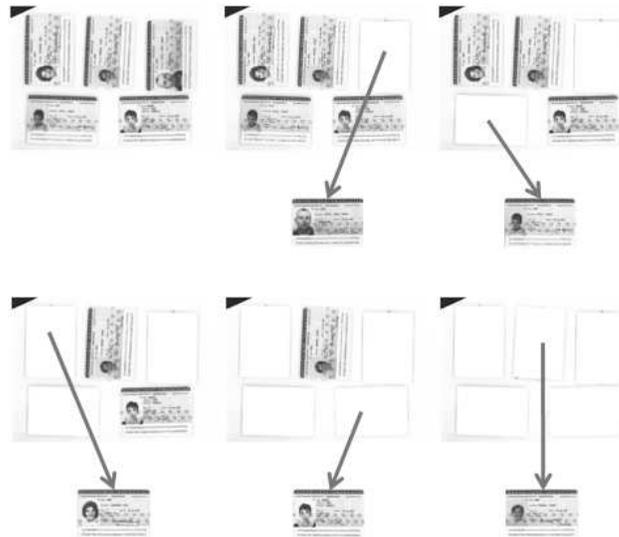
**Figure 9.** Multi-détection. On cherche un modèle dans chaque image. Si un modèle est trouvé, il est supprimé de l'image puis on cherche à nouveau si un modèle est présent sur l'image. On réitère jusqu'à qu'on ne trouve plus de correspondance.
