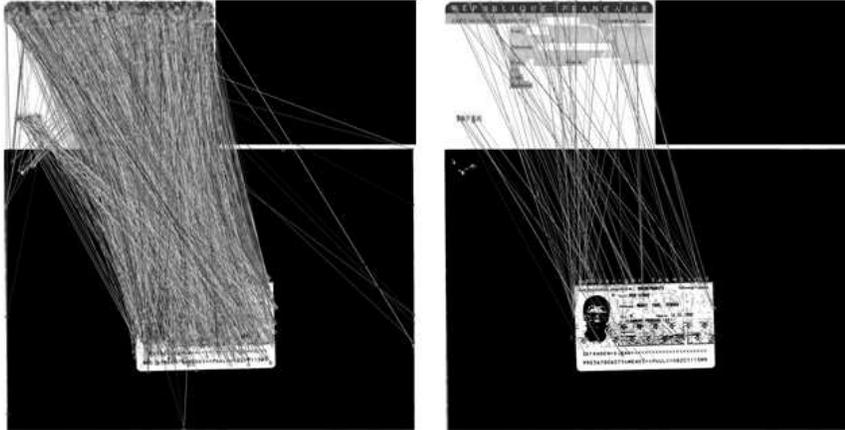
**Figure 5.** Filtrage des points d'intérêts. À gauche : 2438 mises en correspondance sont faites (une pour chaque point d'intérêt). À droite : il reste 78 mises en correspondance après filtrage par unicité, angle et échelle.
