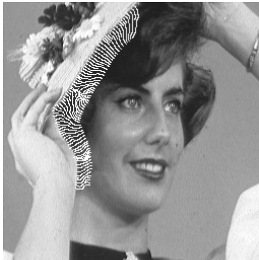
Figure 8.1 : Illustration de l'évolution des sommets d'un contour actif ; le contour actif est initialisé selon une courbe à l'intérieur du visage de la femme et se propage jusqu'à converger vers la limite de la main et du chapeau. La trajectoire de chaque sommet est représentée par un trait blanc
