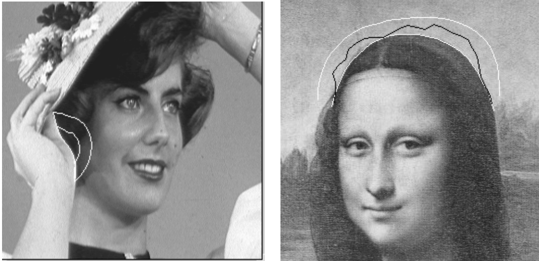
Figure 8.3 : Contour actif ouvert à extrémités fixes et contour actif ouvert à extrémités mobiles. Pour chacun on présente la courbe d'initialisation, une phase intermédiaire et le résultat de convergence
