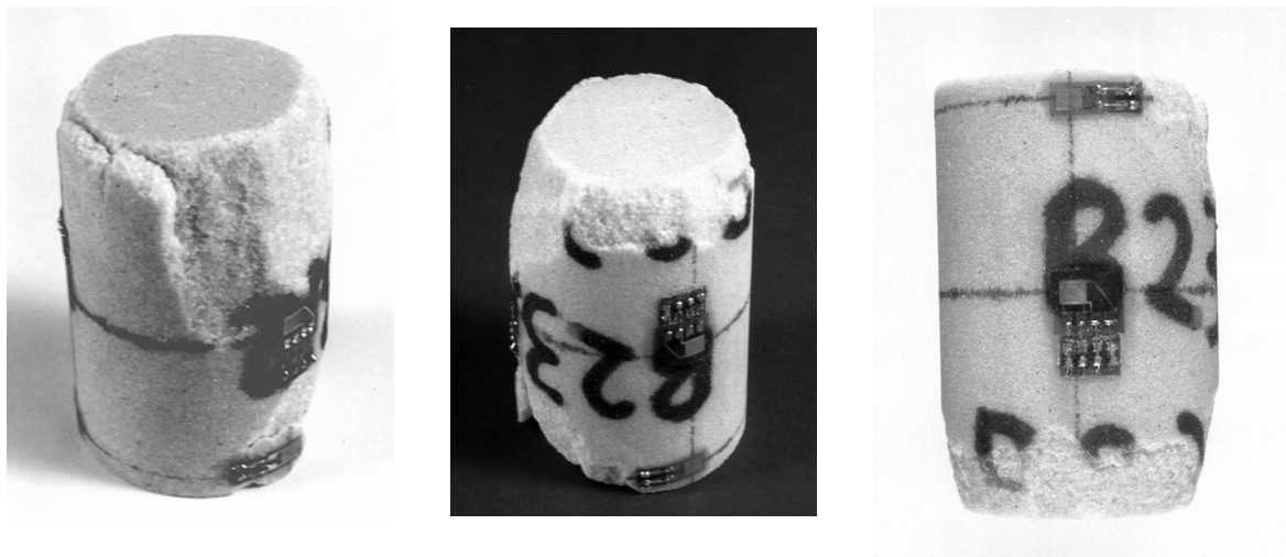
Fig. 5 : Essai B23.2 ; Rupture au niveau des extrémités d'un échantillon testé en conditions lubrifiées avec une protection en plaque de Téflon.
