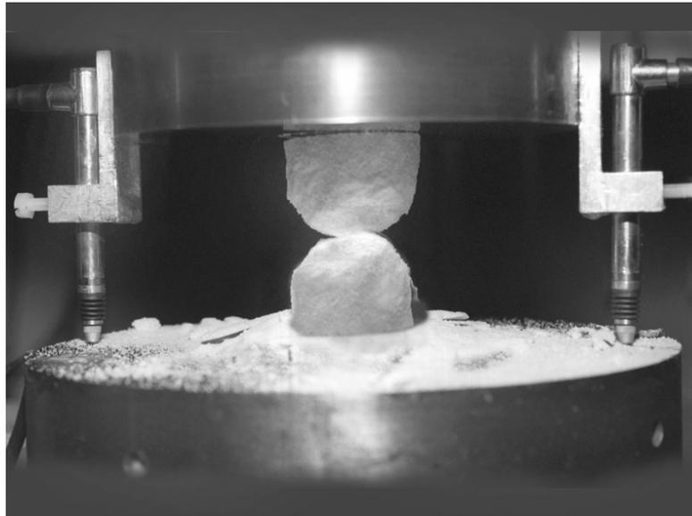
Fig. 13 : Rupture en cône de l'échantillon B15.1
