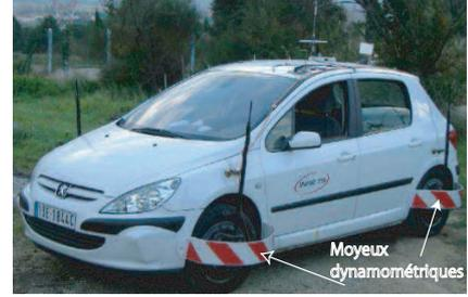
Fig. 3. Véhicule d'essai de l'INRETS-MA.
