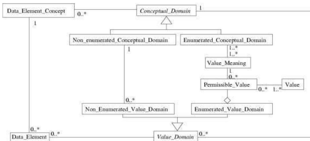
**Figure 4 : Diagramme de classes UML de l'ISO 11179-3**
