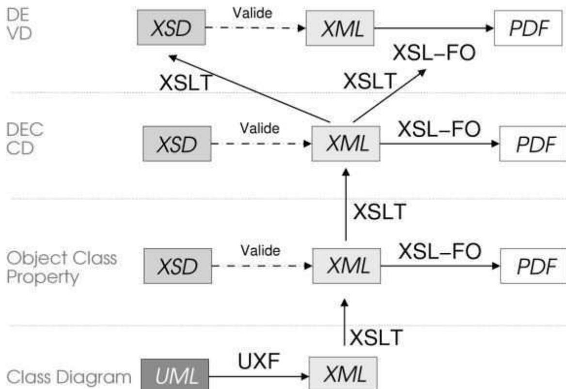
**Figure 6 : Architecture de l'outil de production de schéma compatible avec l'ISO11179-3**
