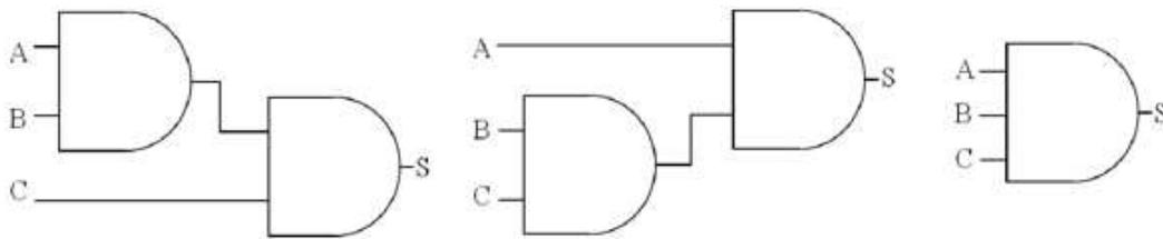
**Figure 8• Exemple de schémas électroniques équivalents**
