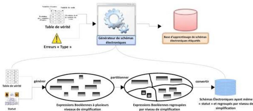
Figure 12• Principe de fonctionnement du générateur de SE
