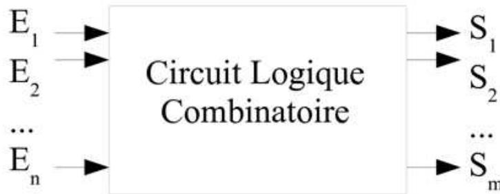
**Figure 3 • Modèle d'un circuit logique combinatoire**
