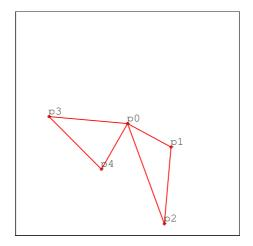
Figure 2: "The butterfly": 2D system with 5 points and 6 distance parameters  $d(p_0,p_1),\,d(p_1,p_2),\,d(p_2,p_0),\,d(p_0,p_3),\,d(p_3,p_4),\,d(p_4,p_0).$
