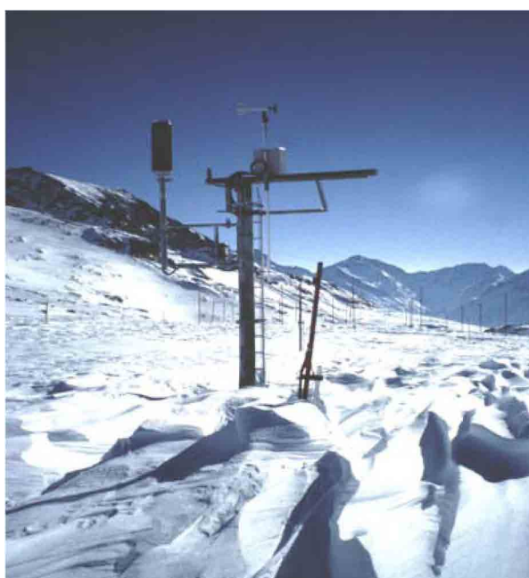
Figure 2 : Station météorologique avec en arrière plan le réseau de perches à neige.
