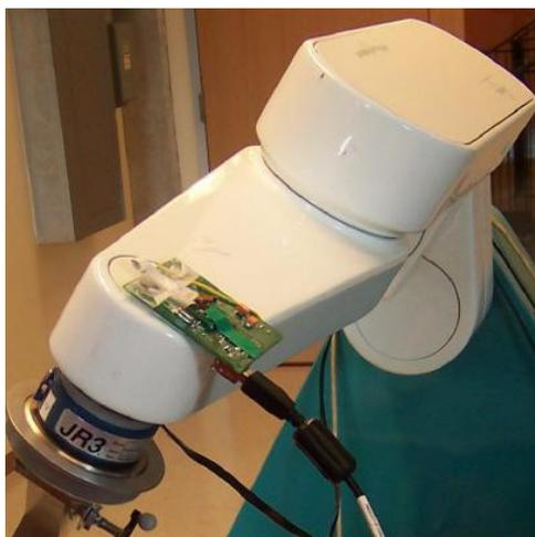
Fig. 2.13. Unité de mesure inertielle attachée à un robot médical
