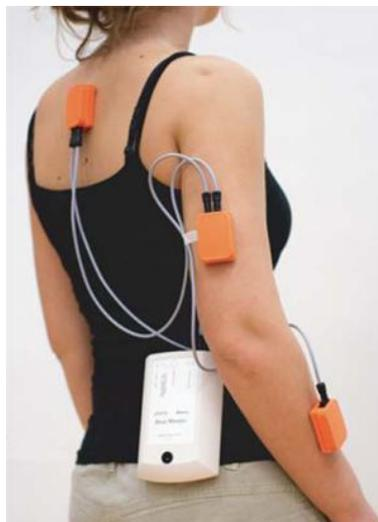
Fig. 2.12. Modules de capteurs attachés aux segments humains
