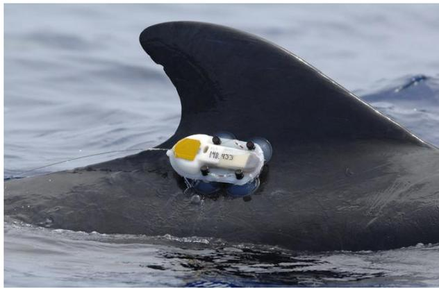
**Fig. 2.14.** Bio-logger contenant un accéléromètre et un magnétomètre triaxiaux, attaché à une baleine
