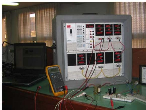
**Prueba de Máxima Tensión.-** Para realizar la prueba de máxima tensión es necesario programar una rampa de voltaje que comience en un valor por debajo del fijado en el relé y empiece a subir lentamente para luego capturar el valor del voltaje en el cual el relé disparará.
