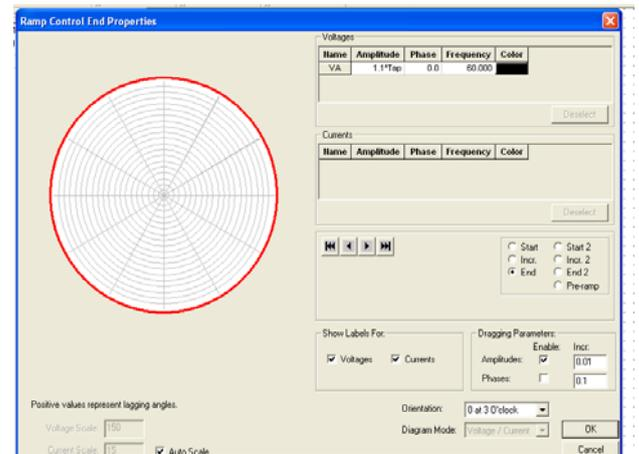
Fig. 6 Control RAMP, ajuste de fin para la prueba de máxima tensión
