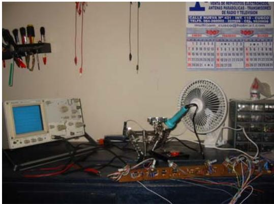
Fig.8 Implementación del Relé de Máxima y Mínima Tensión
