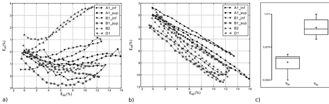
FIGURE 2: a) Déformation transverse  $\varepsilon_{rr}$  en fonction de la déformation longitudinale  $\varepsilon_{\theta\theta}$ . b) Déformation transverse  $\varepsilon_{zz}$  en fonction de la déformation longitudinale  $\varepsilon_{\theta\theta}$ . c) Évaluation des coefficients de Poisson transverses  $\nu_{\theta r}$  et  $\nu_{\theta z}$  à une déformation longitudinale de 10%.
