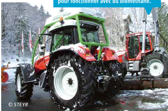
5 Tracteur Steyr CVT 6195, équipé pour fonctionner avec du biométhane.
