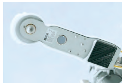
Photo 1b - Le CNR4 (composante réfléchie), instrument permettant les mesures du rayonnement visible et infrarouge.
