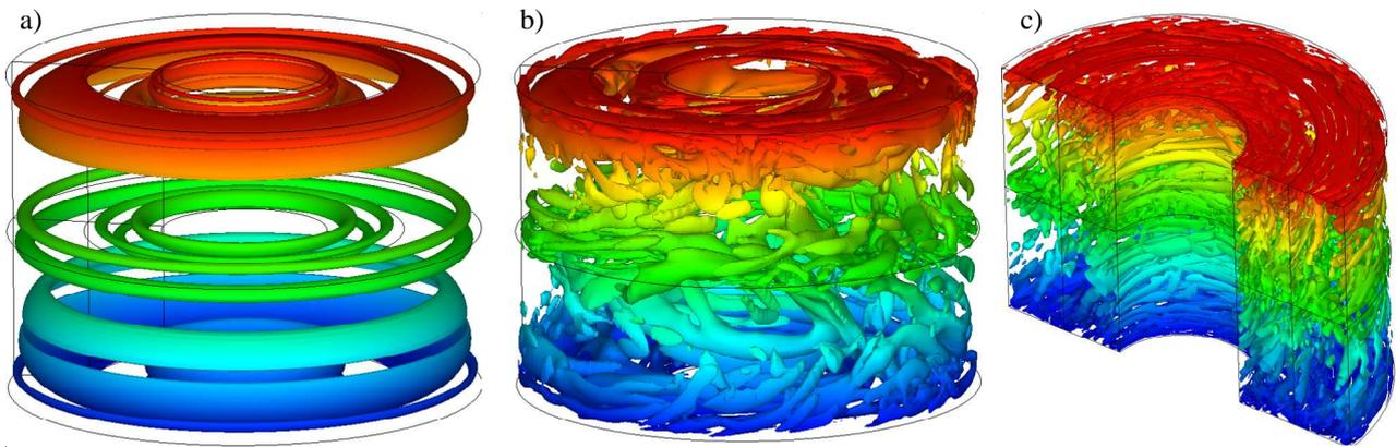
FIG. 2 – Iso-surfaces du critère  $Q$  (colorées par la position axiale  $z$ ) obtenues par DNS pour a)  $Re = 3 \times 10^3$ ,  $iso-Q = 5$ , b)  $Re = 10^4$ ,  $iso-Q = 50$ , c)  $Re = 5 \times 10^4$ ,  $iso-Q = 5000$ .
