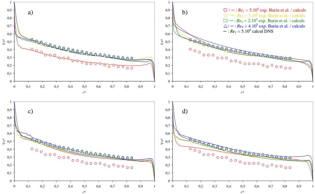
FIG. 4 – Profils radiaux de la vitesse tangentielle moyenne en  $z=H/4$  à  $Re_1=5 \times 10^4$ ,  $Re_2=10^5$ ,  $Re_3=2 \times 10^5$  et  $Re_4=4 \times 10^5$  pour a) le modèle DES Spalart-Allmaras, b) le modèle LES, c) le modèle RSM [6] et d) le modèle  $k-\epsilon$   $v^2 - f$ .
