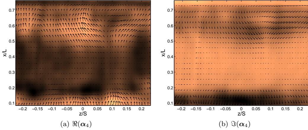
**Figure 7.** Mode dynamique  $\alpha_4(\mathbf{r})$  associé à la fréquence  $f_4 = 1.33$  Hz, repliement de la fréquence des oscillations de la couche cisailée. Les vecteurs représentent  $\Re(\alpha_4)$ ; l'échelle de couleur encode  $\Re(\alpha_4 \cdot \mathbf{e}_x)$ .
