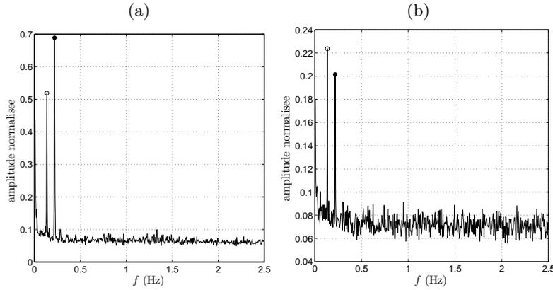
**Figure 4.** Spectre d'amplitude normalisé obtenu par décomposition en modes dynamiques. L'amplitude des canaux fréquentiels est donnée par la norme  $\mathcal{L}^2$  des modes dynamiques  $\alpha_k$  pour les ensembles de mesure (a)  $\{u_x\}$ , (b)  $\{u_z\}$ .
