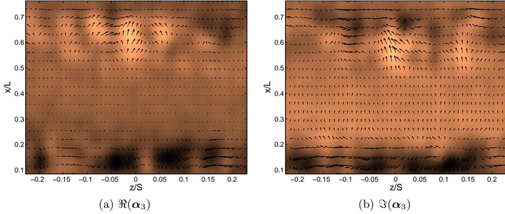
**Figure 6.** Mode dynamique  $\alpha_3(\mathbf{r}) = \alpha_{3,z}\mathbf{e}_z + \alpha_{3,x}\mathbf{e}_x$  associé à  $f_3 = 0.005$  Hz (parties réelle et imaginaire). Les vecteurs représentent la partie réelle du champ vectoriel  $\alpha_3$ ; l'échelle de couleur encode la partie réelle de la projection du champ  $\alpha_3$  suivant  $\mathbf{e}_x$ :  $\Re(\alpha_3 \cdot \mathbf{e}_x)$ .
