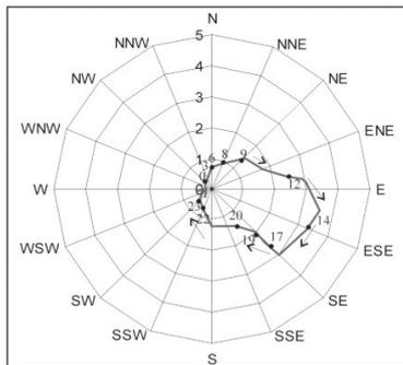
Cette figure donne la direction horaire moyenne (chiffre 0   23) de la brise et sa vitesse (axe vertical de 1   5 m/s).
