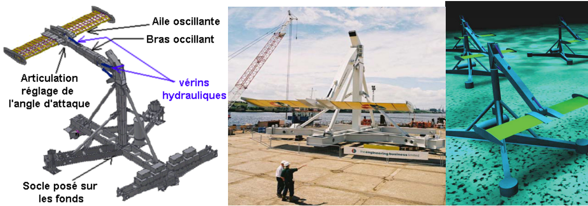
Figure 7.19. Système Stingray (Engineering Business Ltd) à aile hydrofoil : dessin, photographie du prototype et vue d'artiste d'une ferme sous marine [EB 03].
