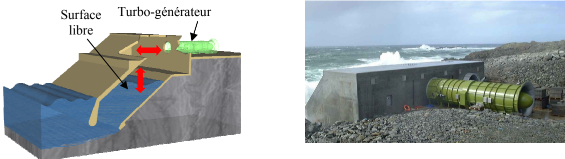
Figure 7.7. Dispositif à colonne oscillante LIMPET [MAC 04], courtesy of Wavegen.
