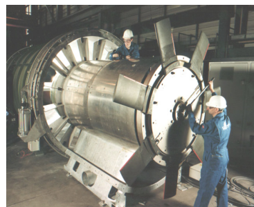
Figure 7.8. Turbogénérateur Wavegen à turbines Wells en cours de montage (groupe de 500 kW), courtesy of Wavegen, [MAC 04].
