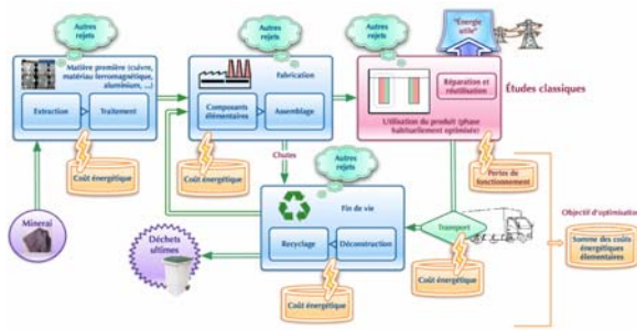
Figure 6 : Schéma représentatif de l'évaluation du « contenu énergétique » sur le cycle de vie d'un produit électrique consommateur d'énergie
