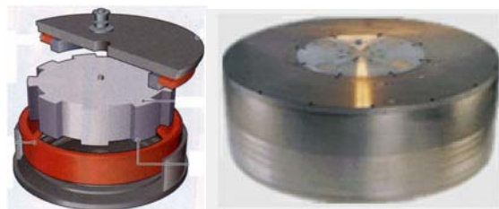
Figure 14. Le système Active Power gamme 160 à 800 kW, masse 1400 à 2250 kg, 7000 tr/min, temps de charge 20 min, temps de décharge 15 à 5 s, machine à réluctance variable, vide partiel, paliers hybrides mécanique + magnétique passif
