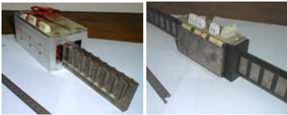
Fig. 28 Exemples d'actionneurs à rail passif et à réductance variable pure (réalisations SATIE)
